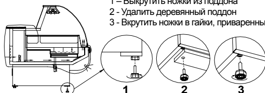
Рис.4 Удаление деревянного поддона
