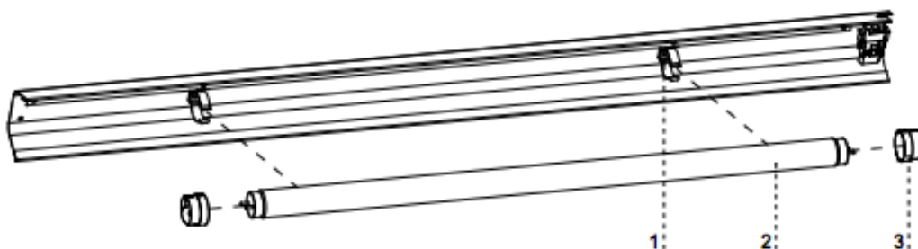
Rys.7 Wymiana świetlówy w lampie
